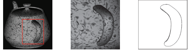
FIGURE 2 – À gauche et au centre : une image de synthèse (parmi huit) d'une théière très texturée, lambertienne. L'écart angulaire moyen sur les éclairages vaut EAM = 14,36 degrés. À droite : détection des pixels où la contrainte d'intégrabilité est violée, avec un seuil s = 0,05 (cf. paragraphe 4.3). En retirant ces pixels de I , on obtient EAM = 9,39 degrés.
