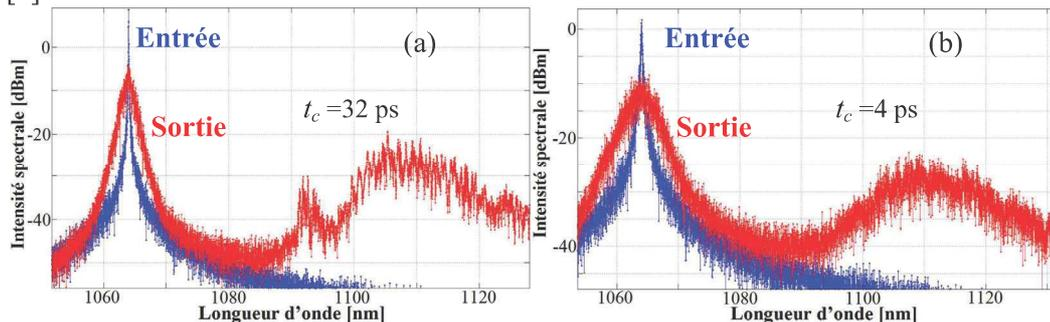
Fig. 2 : Profil spectral moyenné d'un signal laser continu modélisé par une série de 10 processus aléatoires complexes, avant et après propagation dans 5 m de fibre passive (SMF). (a) Le temps de cohérence ( $t_c$ ) du p.a. est de 32 ps ; (b)  $t_c = 4$  ps.
