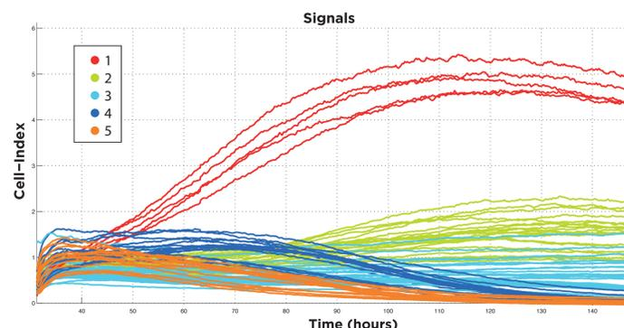
**FIGURE 2.** Signaux types mesurés par impédancemétrie, plus le signal est élevé, plus les cellules recouvrent la surface du fond du puits et inversement. En rouge sont des courbes de contrôle. Les autres couleurs correspondent à la réponse des cellules à un médicament.
