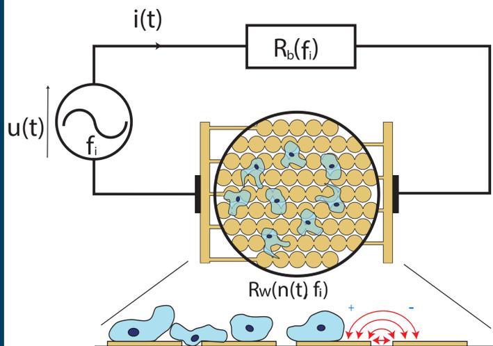
**Figure 1.** Schéma électrique simplifié de l'impédancemétrie. L'interaction puits/cellules modifiant la surface d'échange électrique, augmente la résistivité totale du circuit électrique  $Rw(n(t), fi) + Rb(fi)$  avec  $Rb(fi)$  la résistance de fond et  $n(t)$  le résultat de l'activité cellulaire regroupant le nombre de cellules, leur morphologie, et leur étalement.
