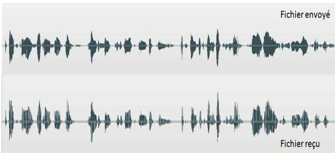
Figure 19 : Transmission avec l'utilisation de codec Speex
