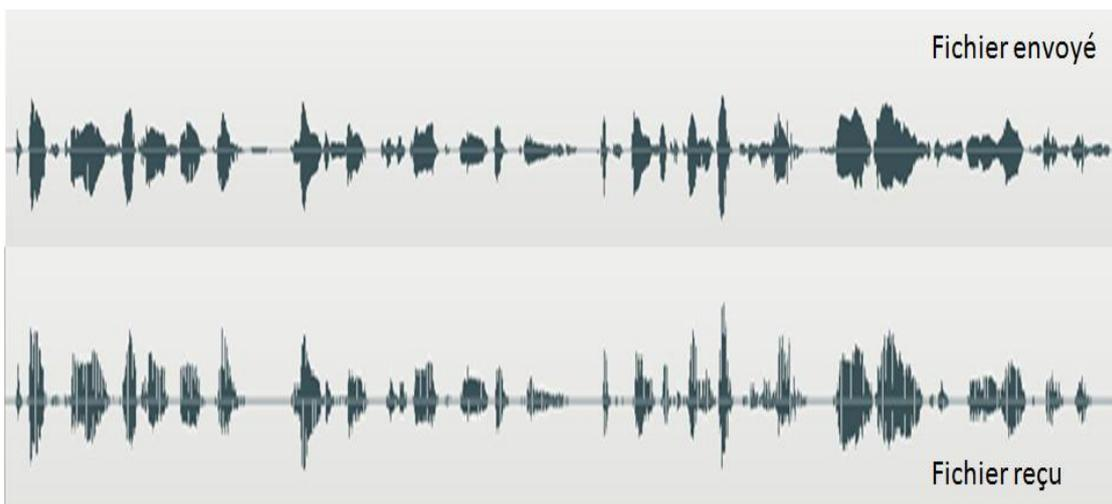
Figure 19 : Transmission avec l'utilisation de codec Speex
