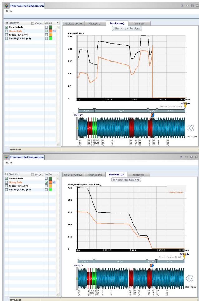
Figure 5: Profils de viscosité (haut) et d'énergie (bas) calculés pour les deux produits (A,-----) et (B,-----) sur un extrudeur bi-vis pilote sur une géométrie de vis standard.
