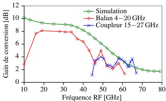
**Figure 7. Gain de conversion simulé et mesuré.**
