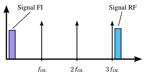
Figure 1. Principe de fonctionnement d'un mélangeur à sous-échantillonnage.
