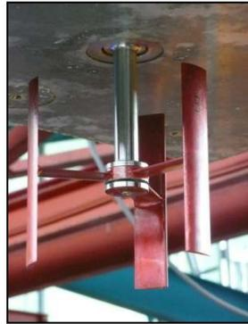
Figure 2 : Modèle réduit de turbine de type Darrieus.
