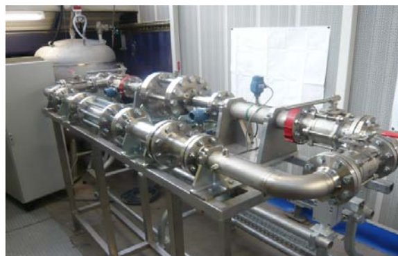
FIG. 2 – Vue de la boucle hydraulique 40 bar, 20 \text{l.s}^{-1} . La pressurisation avale est réglable permettant des études de seuils de cavitation. Cette boucle permet soit de tester hydrauliquement les hélices les plus internes des aimants pour champs intenses, soit d'étudier la thermohydraulique dans un mini-canal plan pour la modélisation des régimes extrêmes.
