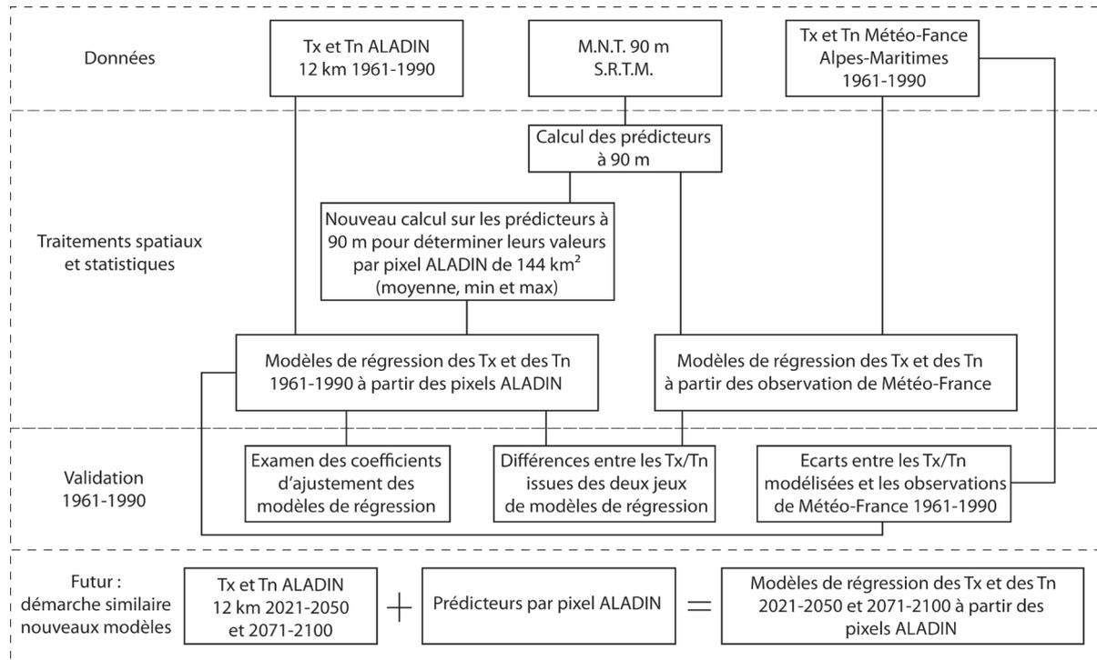
**Figure 3** : Organigramme synthétique de l'enchaînement des traitements pour spatialiser à fine échelle spatiale les sorties de températures d'ALADIN-Climat. *Synthetic organization chart of the chain of processing for mapping in fine spatial scale the outputs of temperatures of ALADIN-Climat.*
