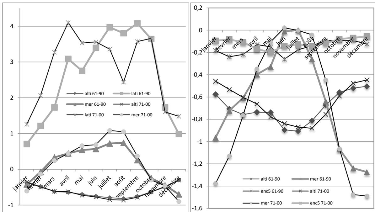
**Figure 7** : Evolution mensuelle comparée des gradients thermiques commandés par les trois principaux prédicteurs des Tx (à gauche) et des Tn (à droite) pour la période 1961-1990 et la période 2071-2100, scénario A1B. *Compared monthly evolution of the thermal gradients commanded by the three main predictors of Tx (left) and Tn (right) for the reference period 1961-1990 and the period 2071-2100.*
