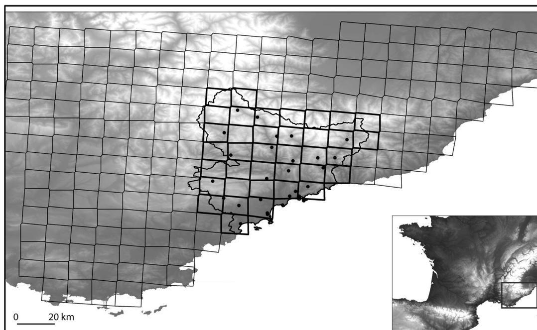
**Figure 2** : Pixels du modèle ALADIN utilisés pour établir les modèles de régression multiple des Tx (37 pixels en gras recouvrant les Alpes-Maritimes) et des Tn (214 pixels). Les points noirs sont les postes météorologiques d'observation qui ont permis de valider le modèle. *Pixels of ALADIN model used to establish the multiple regression models of Tx (37 pixels in bold on the Alpes-Maritimes) and of Tn (214 pixels). Black points are the weather stations which allowed to validate the model.*
