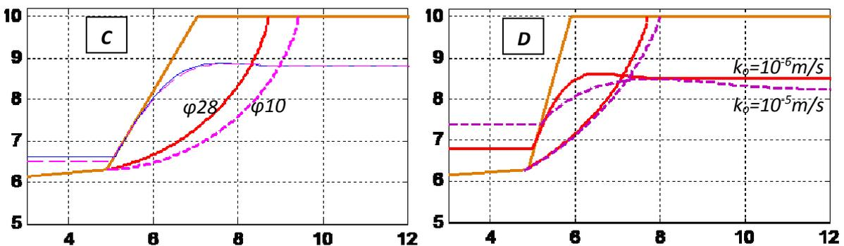
C : Cas  $\beta=60^{\circ}$ ;  $c'=14kPa$ ;  $k_o=10^{-6}m/s$ ;  $\varphi'=10^{\circ}$  Vs  $\varphi'=28^{\circ}$  | D : Cas  $\beta=75^{\circ}$ ;  $c'=14kPa$ ;  $\varphi'=28^{\circ}$ ;  $k_o=10^{-6}m/s$  Vs  $k_o=10^{-5}m/s$
