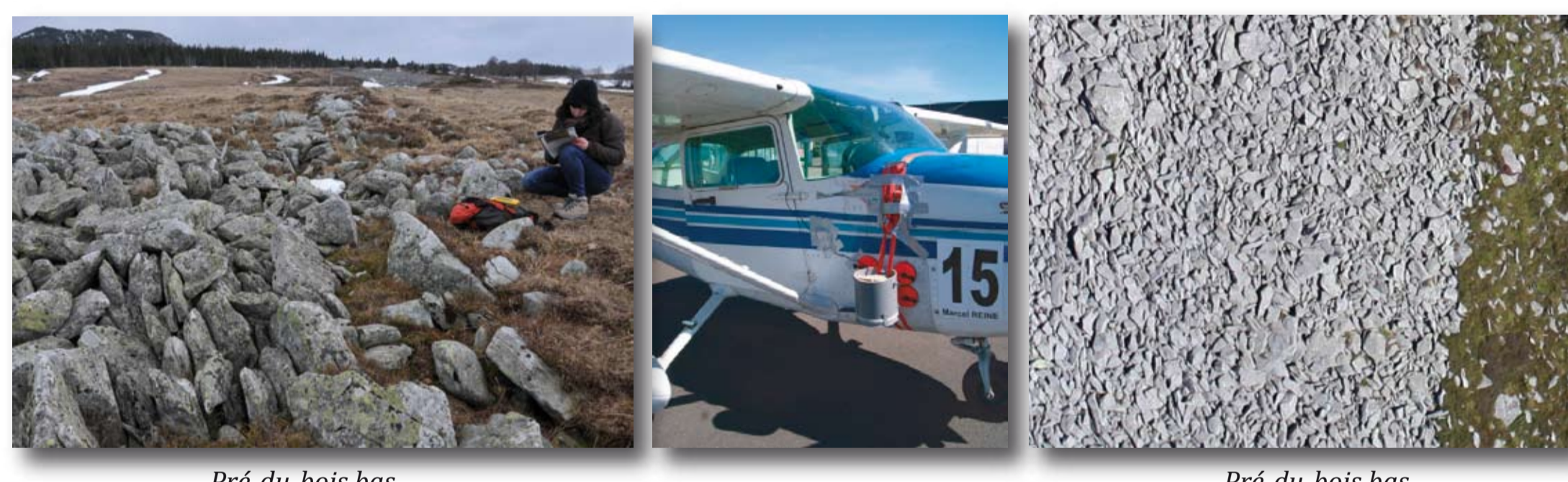
Pré-du-bois bas : étude de fabrication. Mesures effectuées sur le terrain à raison de 5 transects par rivière de pierres et 12 blocs mesurés par transect (donc 60 échantillons)
