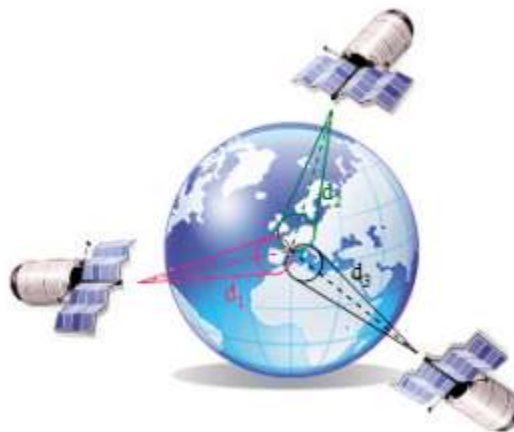
Figure 2. Principe de la triangulation pour géolocaliser un récepteur à la surface du globe. Un quatrième satellite permettra de définir l'altitude (Source : http://www.anr-prodige.com/index.php?n=Technologies.Geolocalisation )
