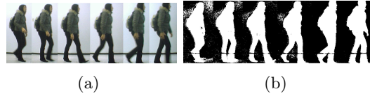
Figura 3: (a) Secuencia de caminata usando morral, capturada en un ambiente con iluminación artificial, (b) resultado de la estimación de fondo Sigma-Delta , 197 cuadros.
