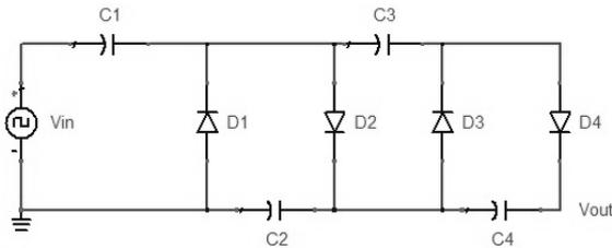
**Figure 4. Circuit élévateur (topologie de « Villard Cascade »)**
