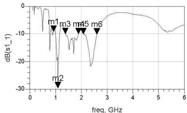
Figure 11. Mesure de l'adaptation de l'antenne
