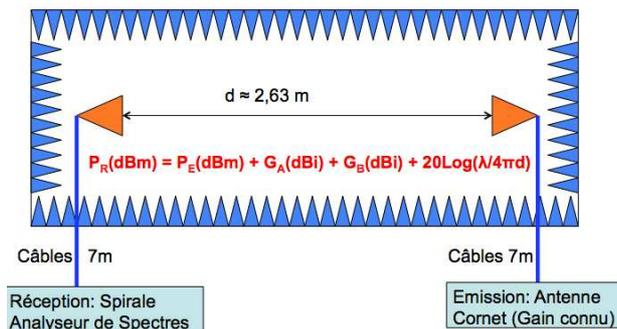
**Figure 12. Protocole utilisé pour la mesure du gain en chambre anéchoïde**
