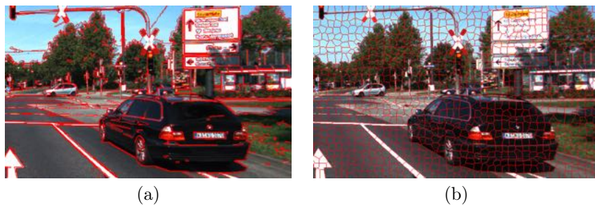
FIGURE 2 – (a) Sur-segmentation obtenue par la méthode de Felzenszwalb et Huttenlocher (2004). (b) Sur-segmentation calculée à partir de l’algorithme SLIC (Achanta et al. , 2012).
