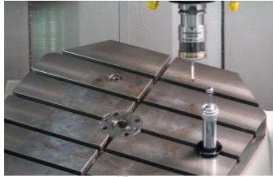
FIGURE 7: MESURE DE V_{XYZ}^{mr} PAR PALPAGE DE LA SPHERE.
