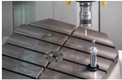
FIGURE 7: MESURE DE V_{XYZ}^{mr} PAR PALPAGE DE LA SPHERE.
