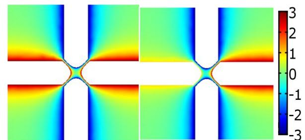
fig 4 : Cartographie du potentiel électrique dans le cas d'un déplacement selon X (échelle en V).
