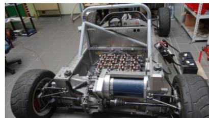
Figure 7 Mise en œuvre de la motorisation électrique
