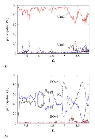
**Figure 26.** Engine order tracking: EO = 1 (---), EO = 2 (----), EO = 3 (----), EO = 5 (----) and EO = 6 (----), (a)  $n_d = 2$ , (b)  $n_d = 4$
