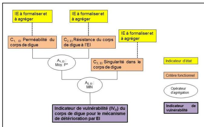
**Figure 1.** Structure d'agrégation pour l'évaluation d'un indicateur de vulnérabilité du corps de digue vis-à-vis de l'érosion interne (C = critère fonctionnel, IE = indicateurs d'état, A = agrégation, IV = indicateur de vulnérabilité, EI = érosion interne)
