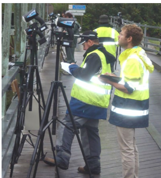
Fig. 2 : Comparaison sur le Rhône à Génissiat les données d'angles et de vitesses sont saisies sur des fiches de terrain.
