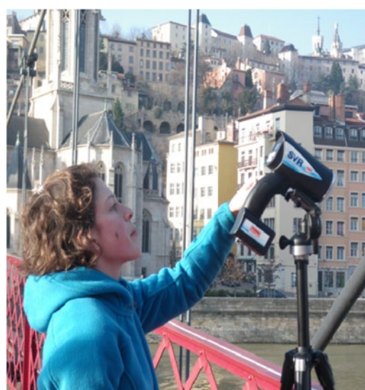
Fig. 3 : Le SVR sur un trépied, le capteur est dirigé vers la surface de l'écoulement, l'opératrice déclenche la mesure (Saône à St Georges).
