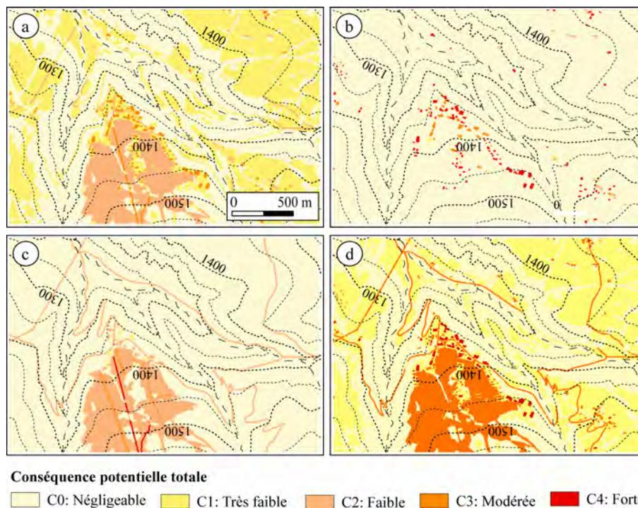
Figure 9. Exemple de cartes de potentiel de dommage structurel et fonctionnel direct  $C_{SF}$  (9a), de dommage corporel direct  $C_C$  (9b), de dommage fonctionnel indirect  $C_{FI}$ , (9c) et de dommage total  $C_T$  (9d) obtenue par une modèle d'analyse semi-empirique. Exemple de la zone d'habitat du Sauze sur le territoire communal d'Enchastrayes.
