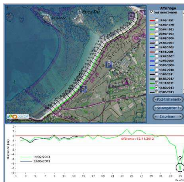
Figure 15 – Evolution du trait de côte entre les mois de novembre 2012 et mai 2013
