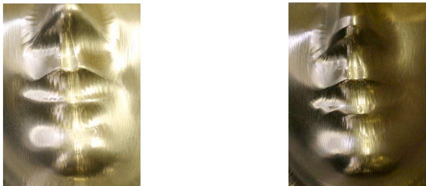
FIG. 5 – Détails des pièces usinées (à gauche copiage, à droite RE)
