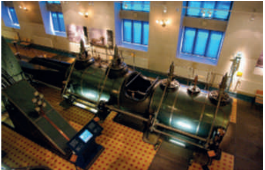
A gauche : le système d'échappement automatisé, au sous-sol de la salle des machines, non accessible au public. © Florent Laroche A droite : Vue d'ensemble de la machine côté Marie, la haute pression vient du piston de gauche (côté cour), Hélène, pour aller ensuite (côté rue) vers Marie à moyenne pression avant de se répartir également à basse pression dans les deux cylindres antérieurs. L'ouverture des alimentations se fait par soupapes commandées via des cames sur l'arbre latéral qui court le long des cylindres. © Jean-Louis Kerouanton
