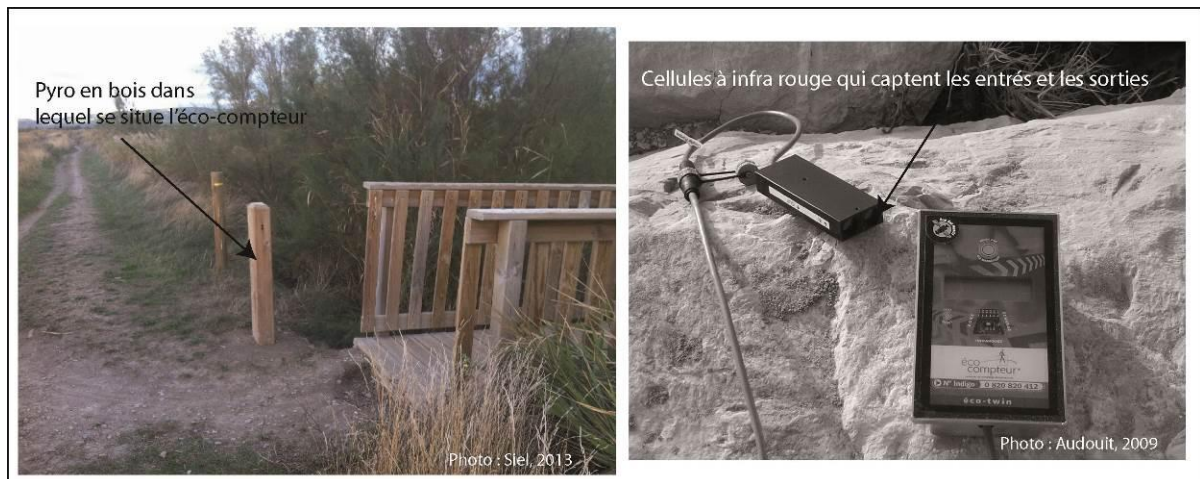
Figure 4 : Type d'éco-compteur sur les Salines de Villeneuve-lès-Maguelone
