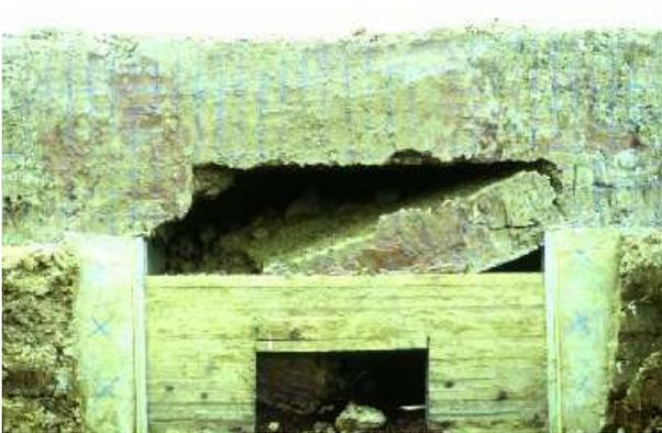
Figure 8. Effondrement de la sous-couche inférieure de l'ouvrage non renforcé lors de la vidange.
