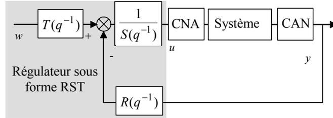
Fig. 5 : Structure de commande numérique sous forme 'RST'.
