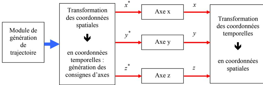
Fig. 1 : Structure générale d'une commande numérique.
