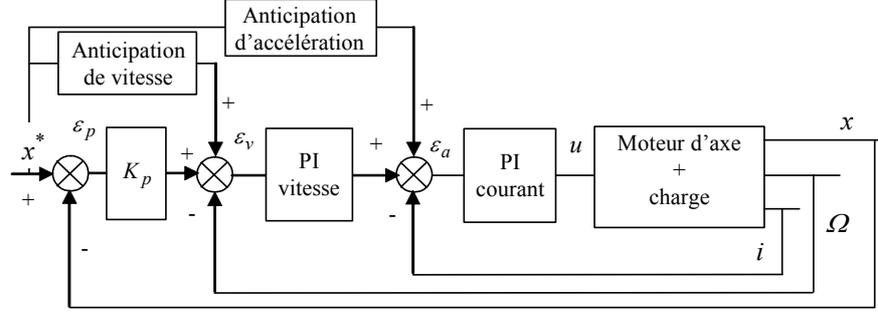
Fig. 3 : Structure classique de commande d'axe.
