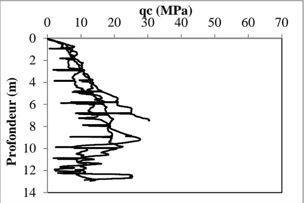
**Figure 17.** Résultats CPT de C2 post-traitement
