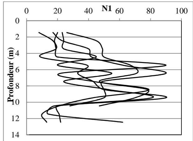
**Figure 12.** Résultats des essais SPT dans la maille D4 après vibrocompactage
