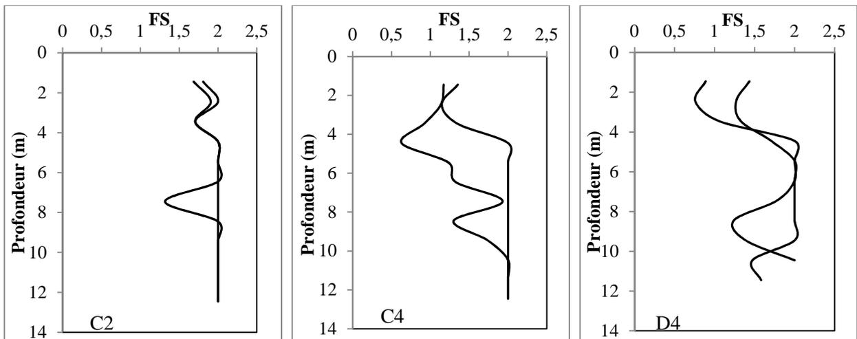
**Figure 13** : Variation de FS après vibrocompactage dans les mailles C2, C4 et D4
