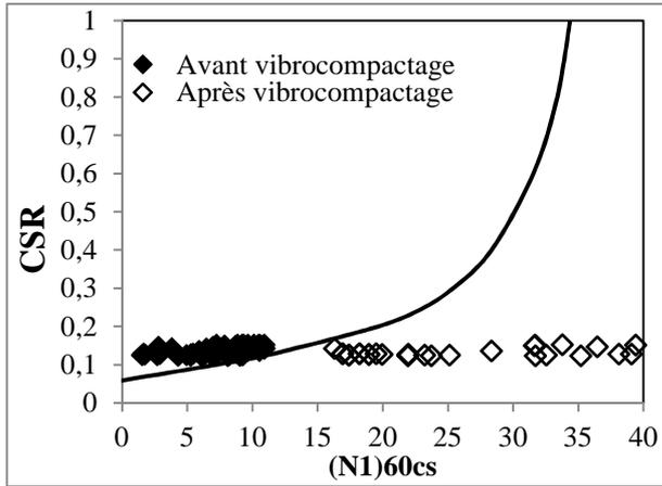
**Figure 9.** CSR en fonction de  $(N_1)_{60cs}$  dans C2
