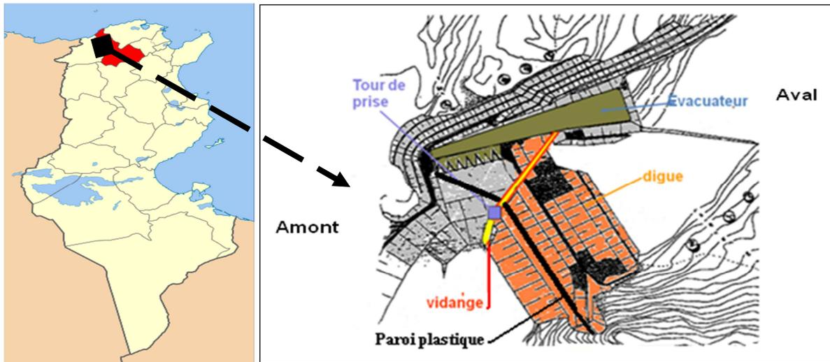
**Figure 1.** Localisation du barrage Sidi El Barrak et description de ses composantes
