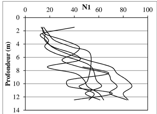
**Figure 10.** Résultats des essais SPT dans la maille C2 après vibrocompactage
