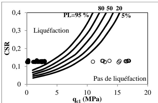
**Figure 41.** CSR en fonction de  $q_{c1}$  dans C2
