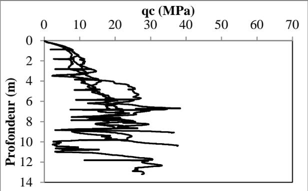
**Figure 18.** Résultats CPT de C4 post-traitement
