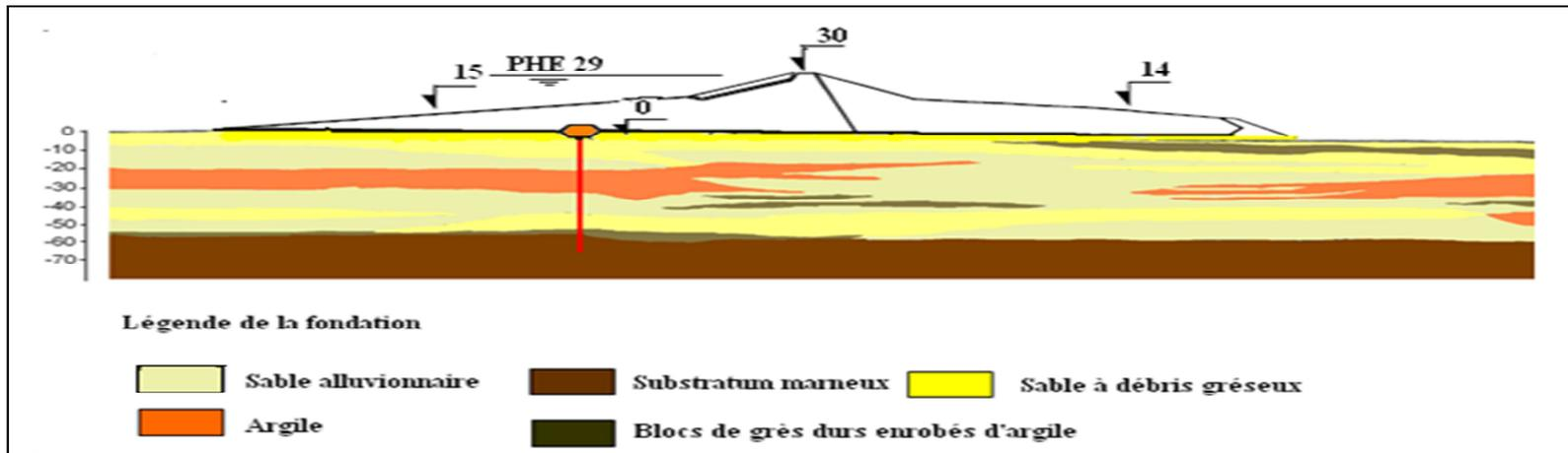
**Figure 3.** Coupe transversale de la fondation du barrage
