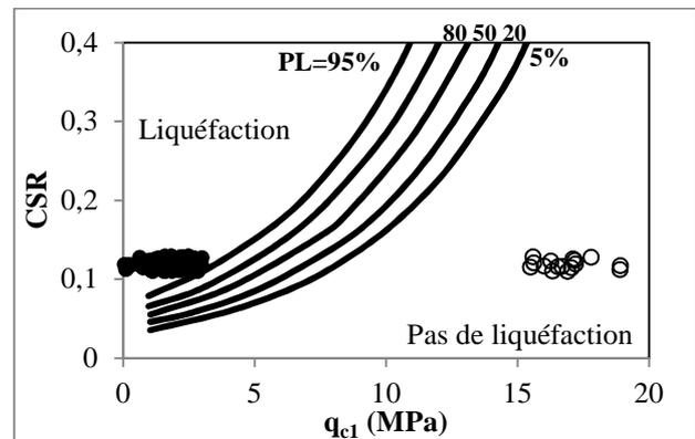
**Figure 42.** CSR en fonction de  $q_{c1}$  dans C4
