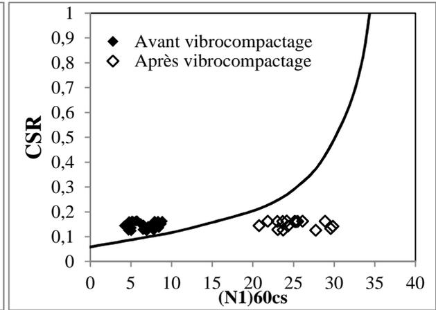
**Figure 10.** CSR en fonction de  $(N_1)_{60cs}$  dans C4
