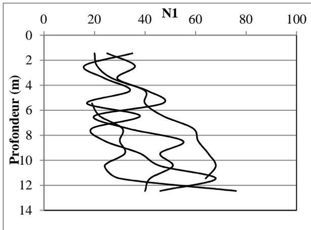
**Figure 11.** Résultats des essais SPT dans la maille C4 après vibrocompactage
