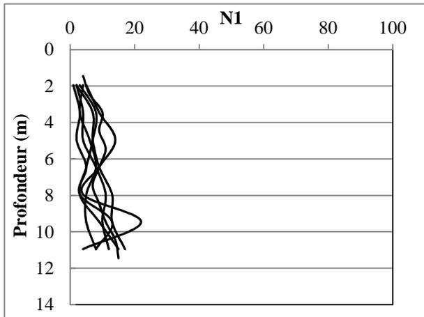
**Figure 9.** Résultats des essais SPT dans la maille D4 avant vibrocompactage
