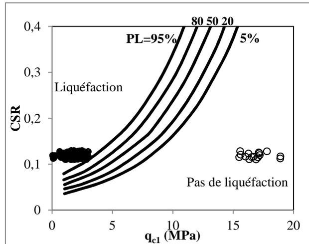
**Figure 43.** CSR en fonction de  $q_{c1}$  dans F3
