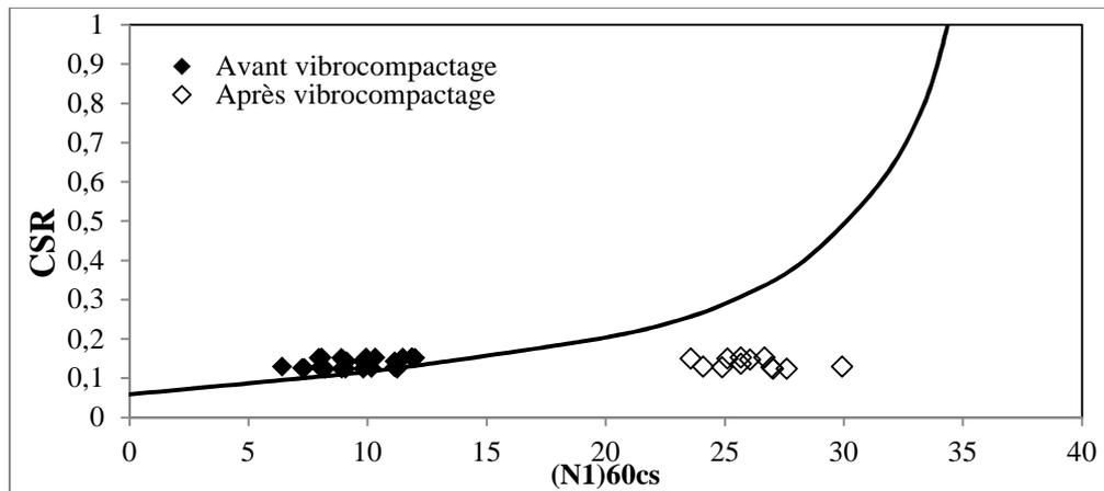
**Figure 11.** CSR en fonction de  $(N_1)_{60cs}$  dans D4
