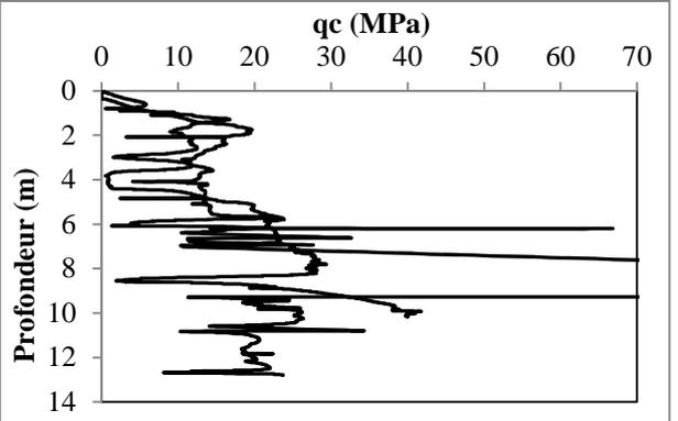
**Figure 19.** Résultats CPT de F3 post-traitement
