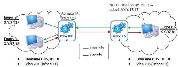
FIGURE 12: Scénario de test du Proxy DDS
