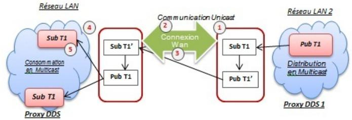
FIGURE 7: Interconnexion des deux proxies DDS
