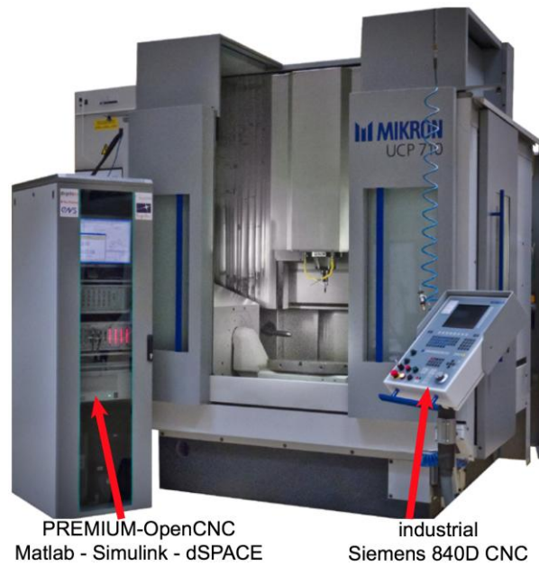
Fig. 5 : Centre Mikron équipé de la CN Siemens 840D à droite et de la CN PREMIUM OpenCNC à gauche.
