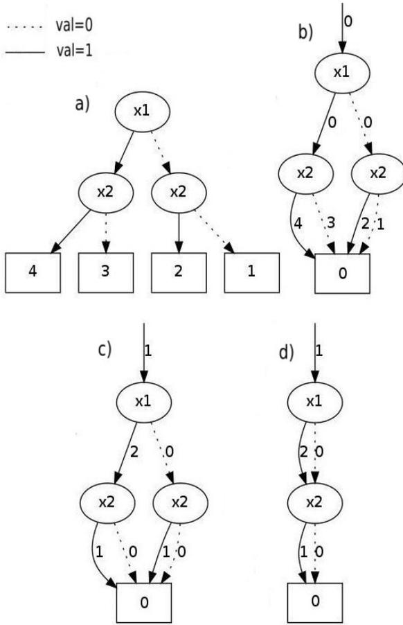
FIGURE 2 – Exemple de traduction d’une formule du langage ADD vers le langage SLDD<sub>+</sub> : (a) formule ADD de départ, (b) les poids sont remontés sur les arcs, (c) les nœuds  $x_2$  puis  $x_1$  sont normalisés, et (d) les nœuds isomorphes sont fusionnés.
