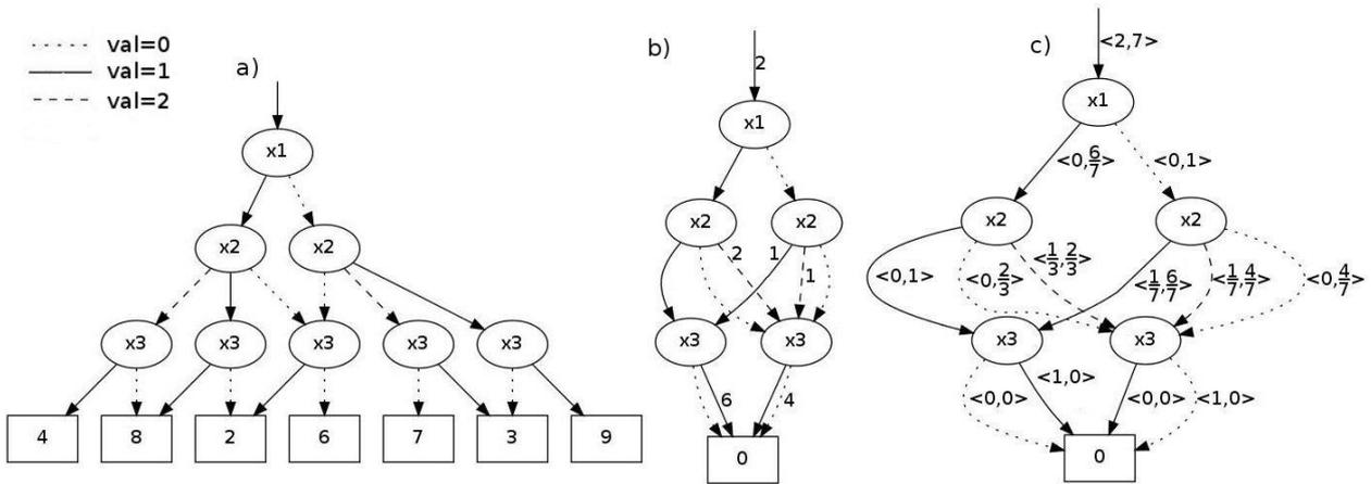
FIGURE 1 – Exemple de VDDs dans trois langages différents, ADD (a),  $SLDD_+$  (b), et AADD (c), tous trois représentant la même fonction sur les variables  $\{x_1, x_2, x_3\}$  avec  $D_{x_1} = D_{x_3} = \{0, 1\}$  et  $D_{x_2} = \{0, 1, 2\}$ .
