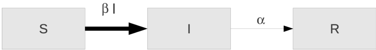
Figure 25. Modèle compartimental de propagation de l'épidémie. Un individu initialement sain (appartenant au compartiment S) va s'infecter (et donc entrer dans le compartiment I) avec un taux de contagion proportionnel (avec un taux \beta ) à la quantité d'individus
