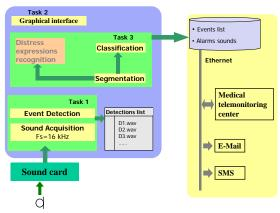
Fig. 2. Real-Time Software Flow-Chart
