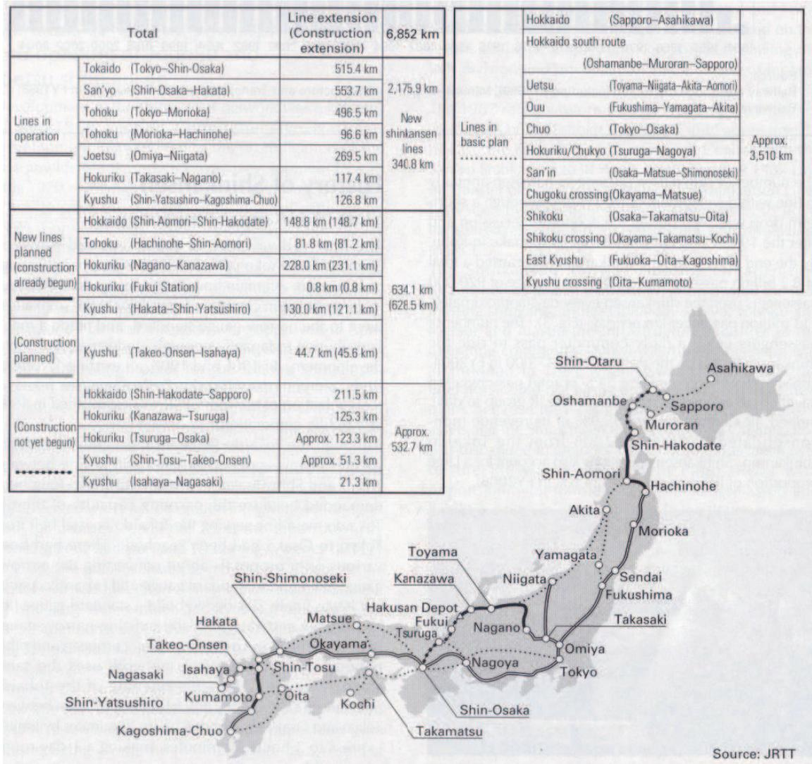
1 - Carta dello stato di fatto e dei progetti per la rete dell'alta velocità ferroviaria in Giappone al 2007. Fonte: "Japan Railway Construction, Transport and Technology Agency" (JRTR) in: *Japan Railway & Transport Review* (JRTR), n°48, agosto 2007, p. 7.
