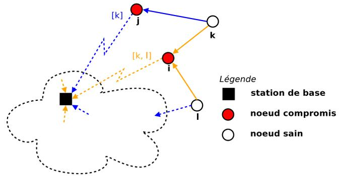
Fig. 2. Exemple de cas dans lequel compromettre  $t$  nœuds ne permet pas de reconstruire des données. Ici  $t = 2$  et les nœuds  $i$  et  $j$  sont compromis. Il n'est cependant pas possible de reconstruire les mesures des nœuds  $k$  et  $l$ .
