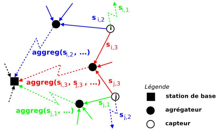
Fig. 1. Principes de base des techniques proposées. Les nœuds  $i$  et  $j$  découpent respectivement leurs mesures dans les parts  $s_{i,1}, s_{i,2}, s_{i,3}$  et  $s_{j,1}, s_{j,2}, s_{j,3}$ . Les parts sont ensuite envoyées et agrégées sur différents chemins.
