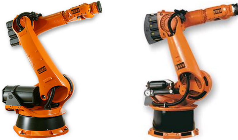
Figure 3: photo des robots Kuka KR270-2F et KR500-2MT
