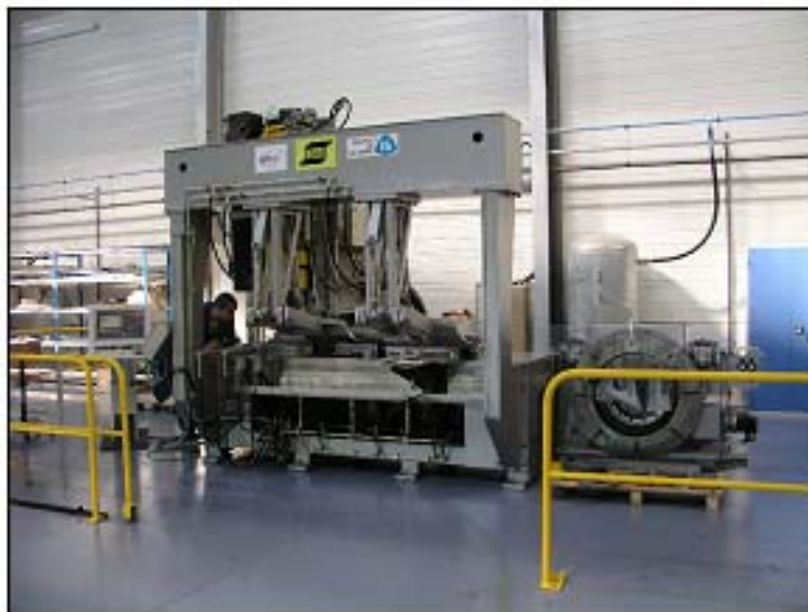
Figure 1: Première machine de FSW en France, de type ESAB (1999)
