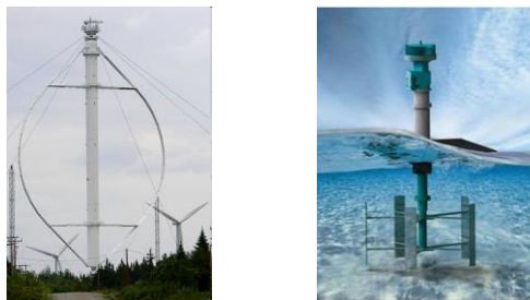
Figure 8.2. Eolienne Sandia (gauche) et hydrolienne New Energy (droite) à flux transverse
