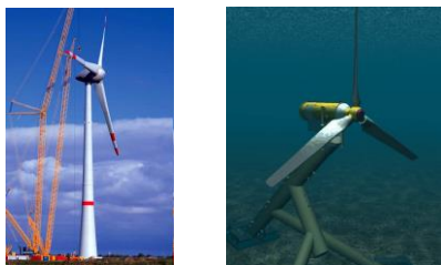
Figure 8.1. Eolienne, Enercon E126 (gauche) et hydrolienne Hammerfest Ström (droite) à flux axial
