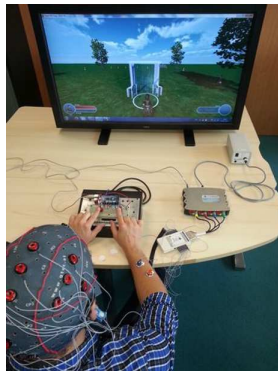
Figure 2 – Notre prototype d'interface BCI hybride
