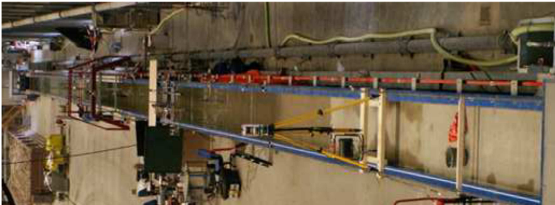
Figure 1 Photographie du canal à houle Scheldt de Deltares.
