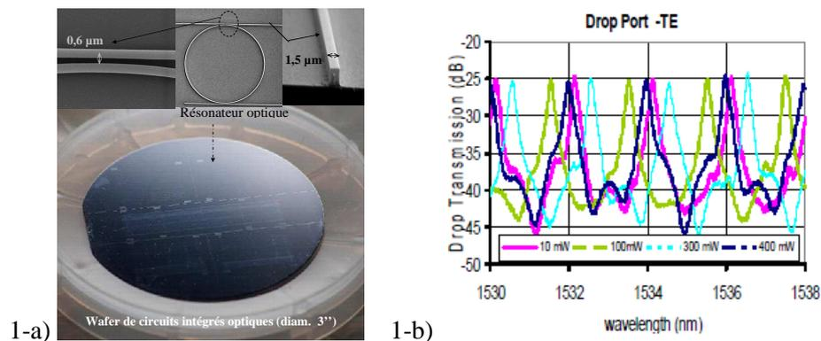
Fig. 1 : - a) Wafer de guides et anneaux en polymères sur silicium ; - b) Exemple de réponse expérimentale du port d'extraction (Drop) de micro-résonateurs polymères à différentes températures.
