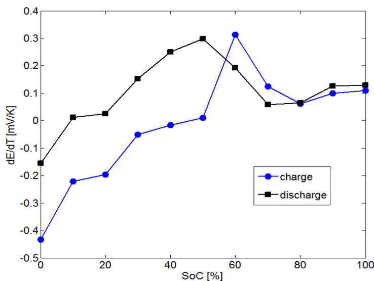
Figure 5: coefficient d'entropie en charge et décharge
