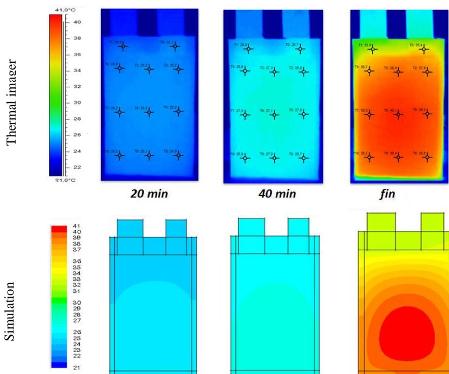
**Figure 7 : Distribution thermique à la surface de la batterie pour un taux de charge de 1It**
