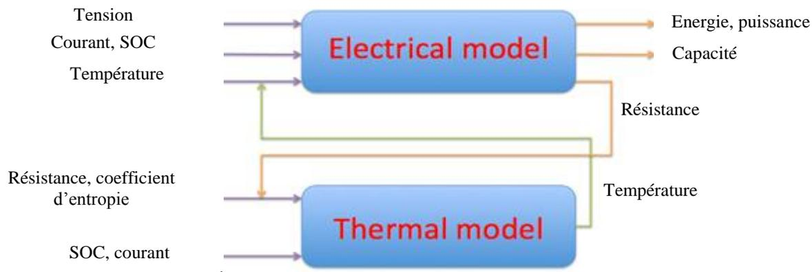
Figure 2 : Principe de base du modèle électrothermique
