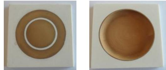
Figure 2. Electrodes d'un échantillon utilisé pour la mesure des courants de conduction
