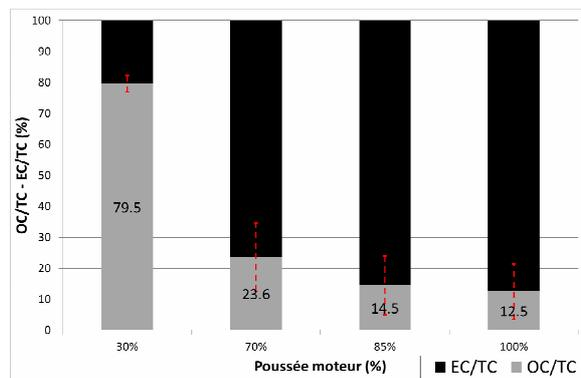
Figure 5. Evolution des ratios EC/TC et OC/TC en fonction de la puissance moteur.
