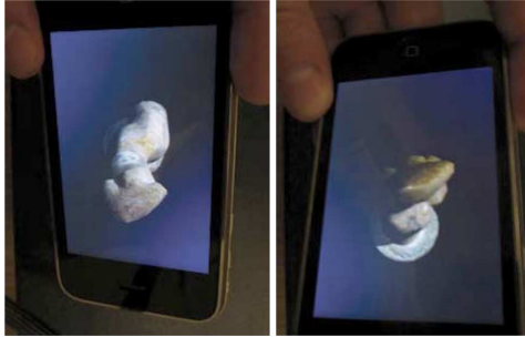
Figure 6: Utilisation de l'anamorphose pour simuler la visualisation d'un objet 3D virtuel sur un smartphone en fonction de l'orientation de celui-ci [EO11].
