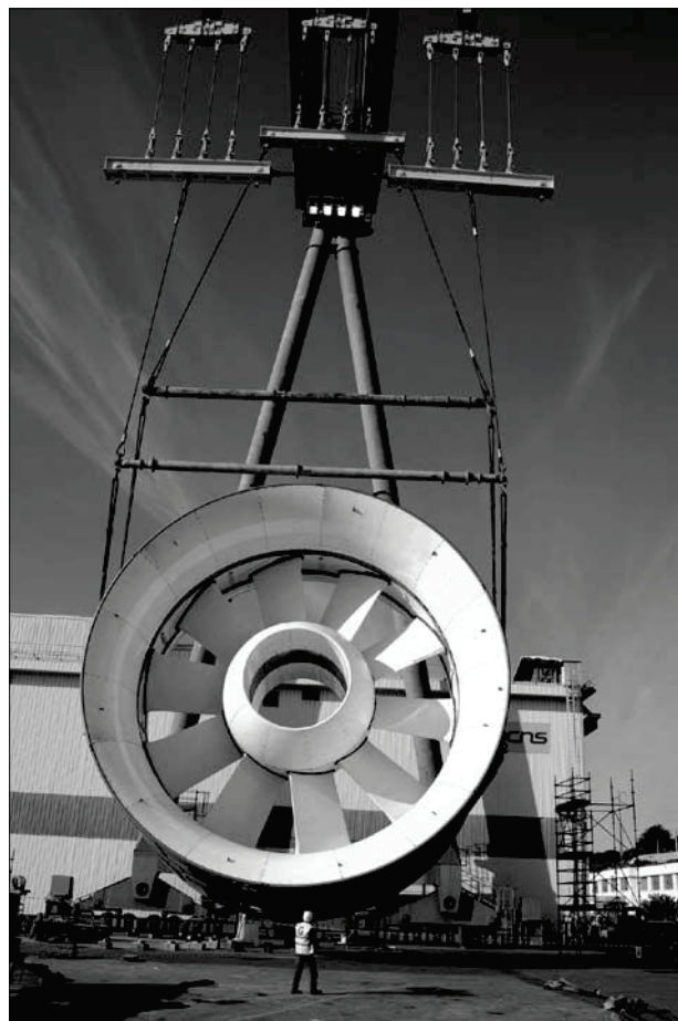
Figure 3 : Déplacement d'une hydrolienne – Crédit photo : DCNS.
